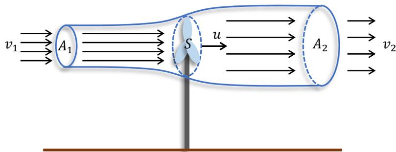
PLTB hanya mampu mengekstrak sebagian dari total daya tersebut. Ketika baling-baling berputar untuk mengkonversi energi, kecepatan udara yang mula-mula sebesar  $v_1$  akan berkurang menjadi  $u$  pada penampang melintang baling-baling dan berkurang menjadi  $v_2$  pada akhirnya. Anggap aliran udara uniform secara radial dan mengikuti bentuk “pipa
