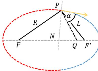
Gambar di atas adalah penyederhanaan dari lintasan orbit rudal. Titik P adalah titik peluncuran rudal yaitu kutub utara bumi. Titik  $F$  dan  $F'$  adalah titik fokus elips dimana  $F$  adalah titik pusat bumi (pusat bumi harus terletak di salah satu titik fokus elips). Garis berwarna abu-abu adalah garis normal terhadap elips. Garis PQ adalah garis singgung permukaan bumi, garis ini tegak lurus permukaan bumi. Sudut  $\alpha$  sendiri adalah sudut peluncuran rudal.
